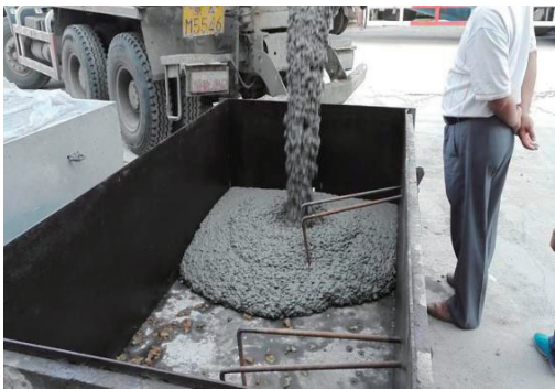
HZ-5 出机坍落度240、扩展度650 HZ-5 18h后坍落度220、扩展度460
