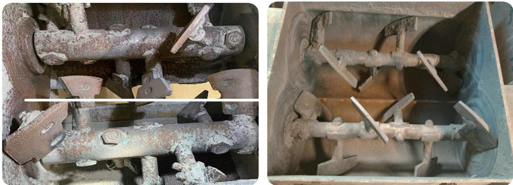
图3 实验用振动式搅拌机和双卧轴搅拌机
