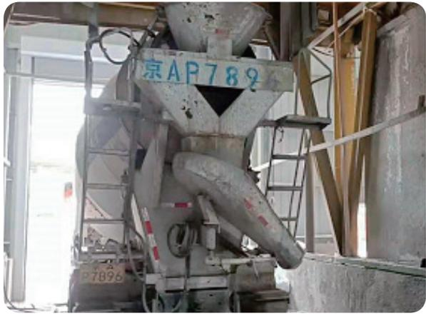
图4-7 运载耐辐照混凝土的罐车
