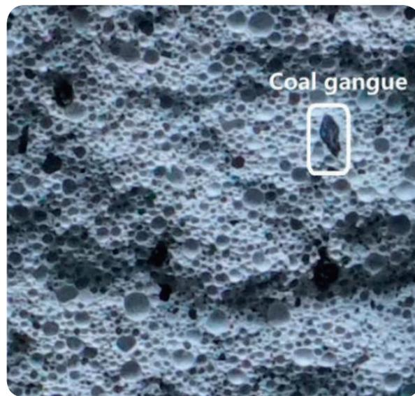
图2 免烧煤矸石泡沫混凝土的断面
