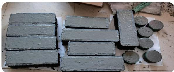
图4-5 施工现场留置的混凝土试块照片
