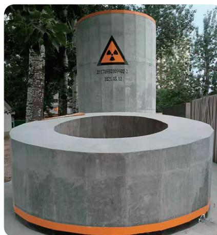
图5-1 示范工程的乏燃料干法贮存容器完成效果图片
