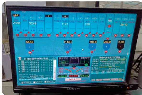
图4-6 搅拌站中控室混凝土原材料计量系统控制界面
