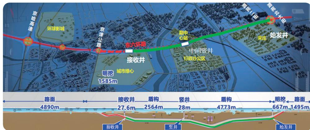
图1-1 东六环入地改造线路及盾构井布置图
