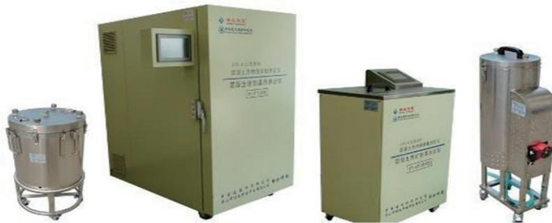
图4.3 混凝土热物理参数测定仪
