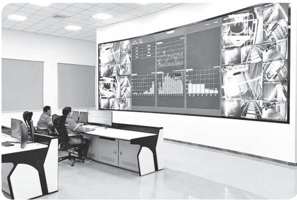
迈进西北旺站，智能化气息扑面而来。站内采用数智化生产设备，原材料溯源系统、混凝土出厂自动检测系统、智能中控室等智能系统、设备均已投入使用，全方位提升混凝土生产全过程自动化水平。实现一机双控全覆盖，试运行智能过磅系统，搭建可视化管控平台，智能调度系统和视频监控系统有效对生产用车进行动态调配控制，以保证施工现场的高效运作和资源的合理使用，远程集中工控系统完成8条生产线搭建，预计2025年实现全面投入使用，进一步提高生产效率，实现生产运营数据和视频监控影像的数字集成。
