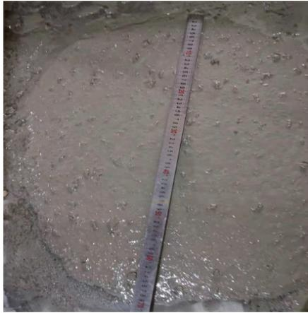
图5.3-1现场实测混凝土扩展度
