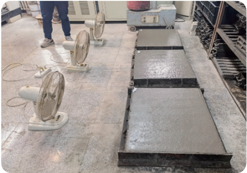
图1总开裂面积试验
